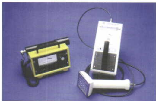
این دستگاه برای شمارش و اندازه گیری ذرات آلفا مورد استفاده قرار می گیرد
